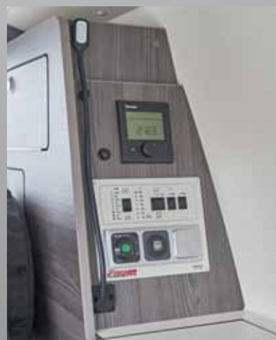
Alles im Blick: Bedienteil für Heizung, Kühlbox, Ladegerät und optionale Warmwassertherme. Kontrolle für Batterien und Abwasser, Anschlüsse zur Stromversorgung in 12V/230V/USB, LED-Schwanenhalslampe. Großes Staufach - Für portable Toilette. In diesem Fach können optional zwei Schubladen untergebracht werden - für noch mehr Stauraum.
