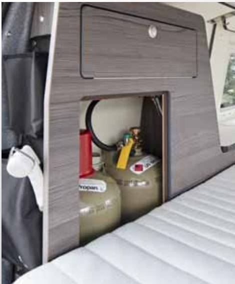
Gaskasten für 2 x 5 kg Gasflaschen - Gut zugänglich für die optimale Versorgung des Gaskochers und der Gas-Standheizung. Außendusche mit Brauseschlauch serienmäßig (Warmwasserversorgung immer vorbereitet), 20 - 60l Frischwasserversorgung mit Kanister. Gassteckdose mit 5m Anschlußschlauch zur Versorgung des herausnehmbaren Gaskochers.
