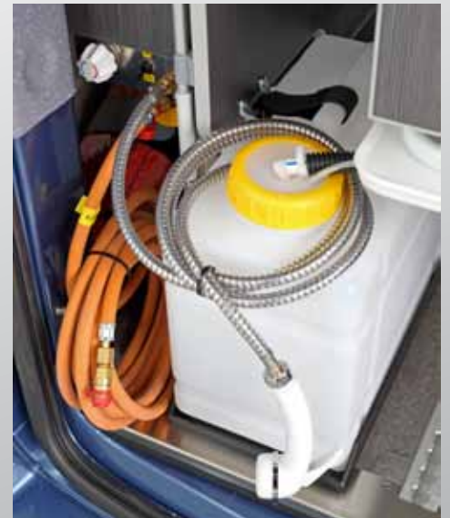
Gaskasten für 2 x 5 kg Gasflaschen - Gut zugänglich für die optimale Versorgung des Gaskochers und der Gas-Standheizung. Außendusche mit Brauseschlauch serienmäßig (Warmwasserversorgung immer vorbereitet), 20 - 60l Frischwasserversorgung mit Kanister. Gassteckdose mit 5m Anschlußschlauch zur Versorgung des herausnehmbaren Gaskochers.
