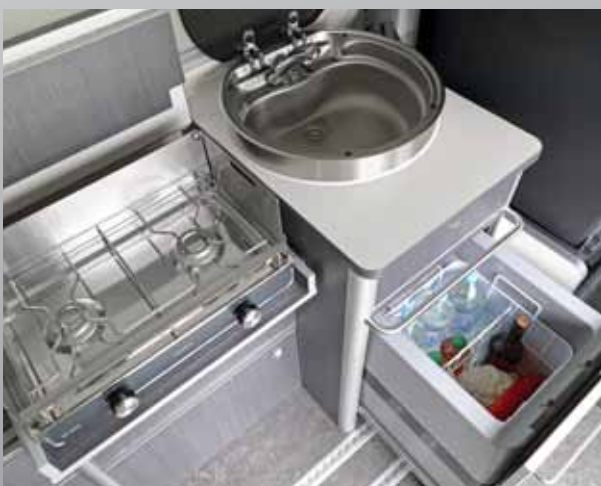
2-Flamm-Gaskocher - Aus Edelstahl mit Flamm- und Windschutz, mit einem Klick herausnehmbar und im Freien verwendbar, auch als Grill mit optionaler Grillplatte. Spülbecken - Mit Mischarmatur und Glasabdeckung. Kompressorkühlbox - Hocheffizient mit 36L-Volumen.
